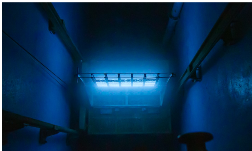
Fig. 7. Rastrelliera con 25 sorgenti di Cobalto 60 posizionata sul fondo della piscina di stoccaggio della facility Calliope del C.R. ENEA Casaccia. Su concessione del C.R. ENEA Casaccia.
