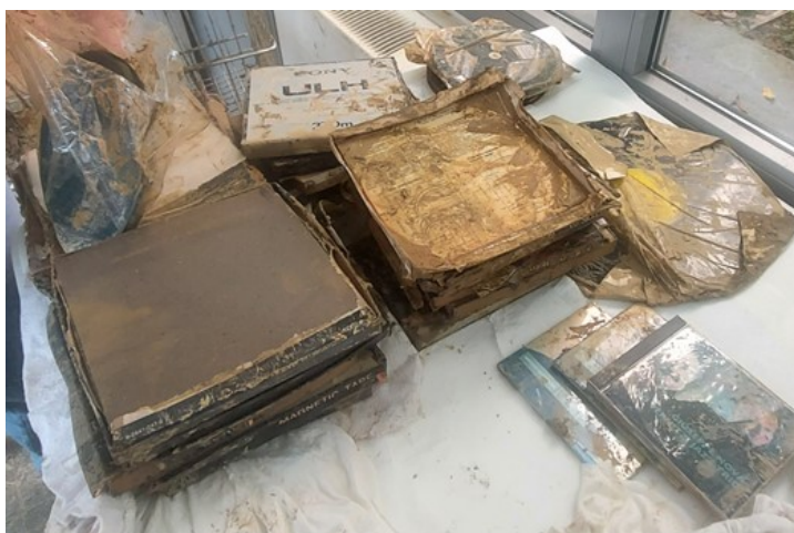
Fig. 8. Nastri magnetici e dischi ottici contenuti nelle confezioni di carta e plastica originali e impregnati di acqua e fango a seguito di alluvione. Foto: Rita Capitani.
