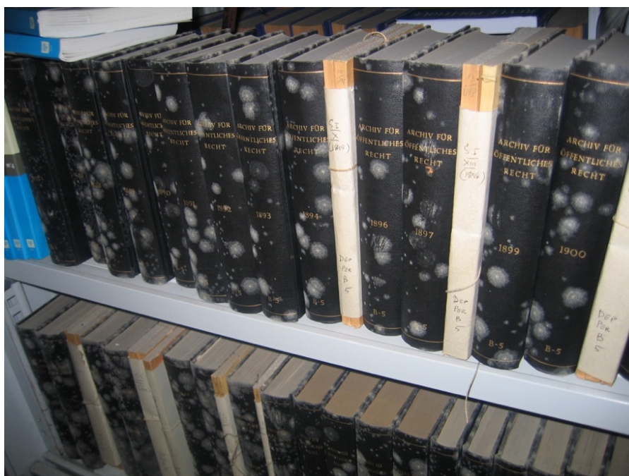
Fig. 4. Sviluppo di colonie fungine su dorsi e tagli di volumi dopo variazioni marcate di umidità relativa e temperature dovute al malfunzionamento di impianti di climatizzazione. Foto: Maria Carla Sclocchi.
