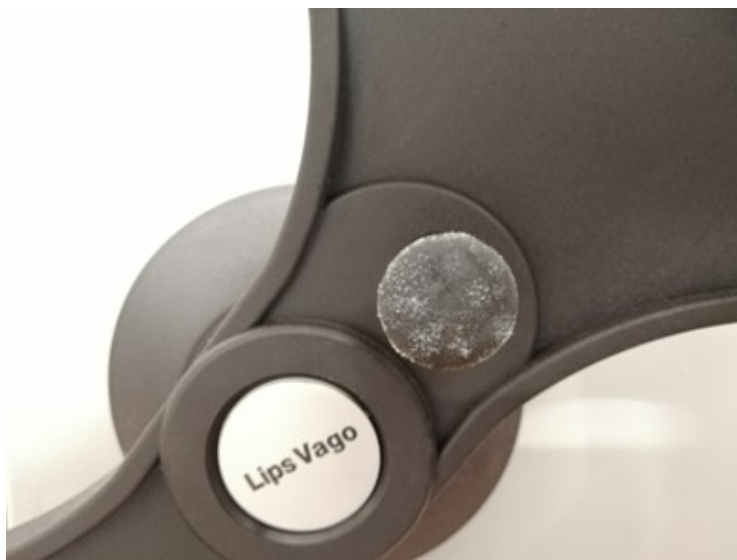
Fig. 13: Infezione fungina su elemento plastico di una scaffalatura compatta. Foto: Matteo Montanari.
